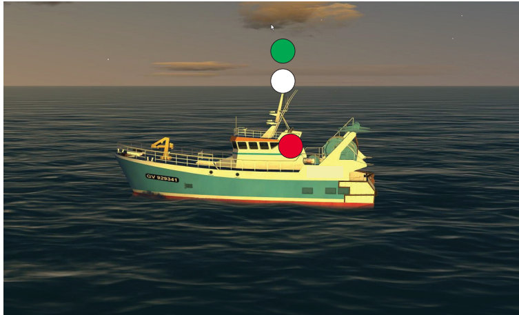
1.3.7.B. — Chalutier avec erre de longueur inférieure à 50 m - Les feux vert et blanc sur le mât sont visibles sur tout l'horizon (Règles 26 b-i et 26 b-iii).
