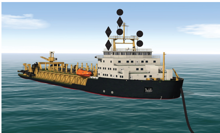
1.3.8.M. — Drague au mouillage avec obstruction à bâbord - Marques de jour (Règle 27 d-iii).
