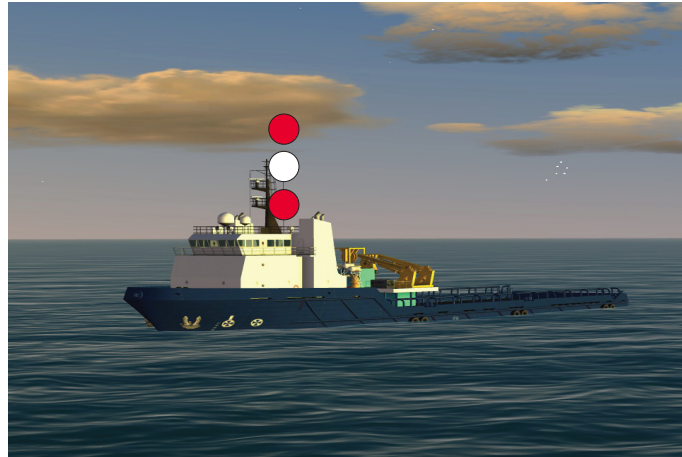
1.3.8.E. — Navire à capacité de manœuvre restreinte sans erre - Les feux verticaux rouge blanc rouge sont visibles sur tout l'horizon (Règle 27 b-i).
