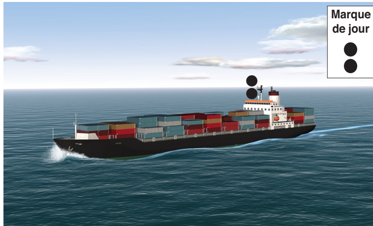
1.3.8.B. — Navire non maître de sa manœuvre avec ou sans erre - Marque de jour (Règle 27 a-ii).
