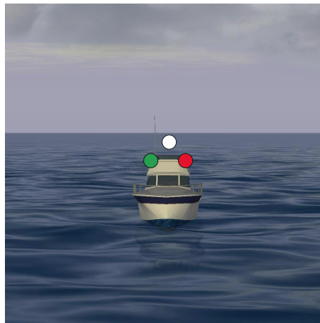
1.3.4.D. — Navire à propulsion mécanique de moins de 12 m de long (Règle 23 d).
